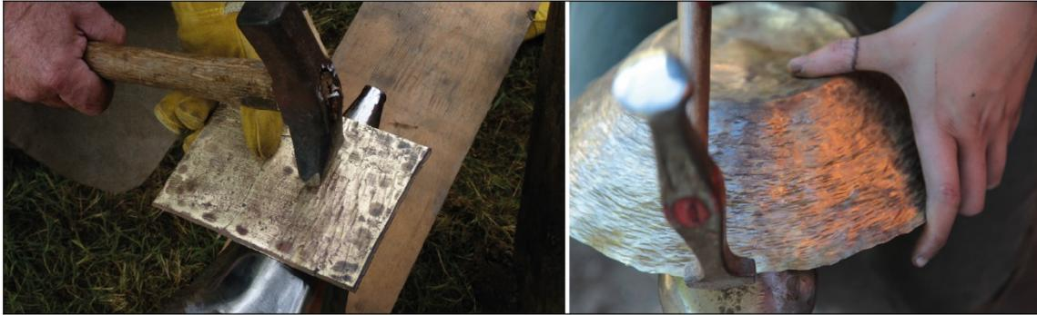
*Fabrication expérimentale d'une ébauche destinée au martelage et d'un récipient, ici en laiton, juillet 2015, plateforme d'expérimentations de Barsy (Belgique).*
