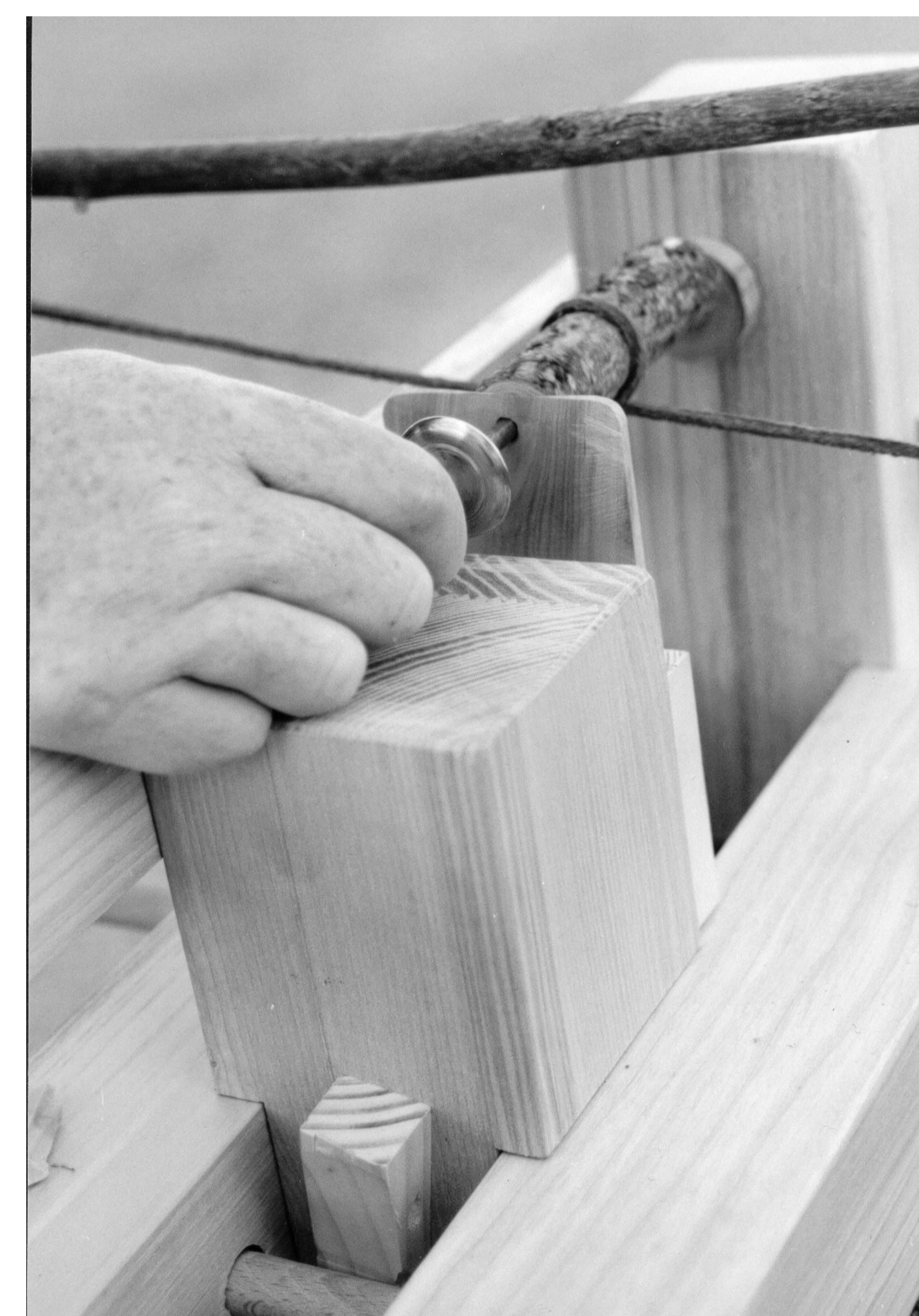
Tour à archet expérimental réalisé par C. Picod (cliché C. Picod)
